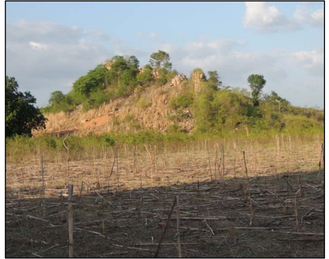
Foto 2.2 - Ombreira direita: afloramento de quartzito (crista), rodeado superficialmente por talus (blocos e matacões rolados de quartzito) (E=302.167; N=9.582.117).
